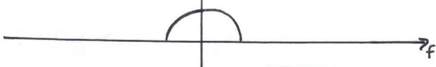
Analog für  $-y(t) \cdot \sin(\omega_0 t) = \boxed{\frac{1}{2} y_Q(t)} - \boxed{\frac{1}{2} y_I(t) \sin(2\omega_0 t) - \frac{1}{2} y_Q(t) \cos(2\omega_0 t)}$
