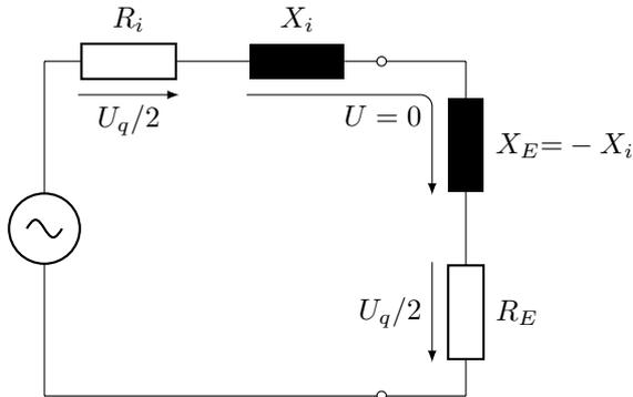
**Leistungsanpassung** (maximale verfügbare Leistung)
