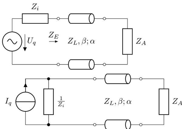
Äquivalent mit  $U_q = I_q \cdot Z_i$ . Aufpassen: Angegeben an Quellen sind immer Spitzenwerte. Alle angegebenen Größen sind komplexe Phasoren.
